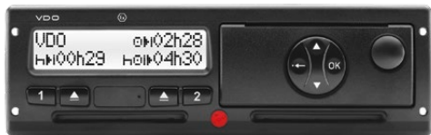
2e onafhankelijk snelheidssignaal (IMS) EU besluit: digitale tachografen op voertuigen > 3.5 ton dienen uitgerust te zijn met een tweede onafhankelijk snelheidssignaal IMS.
