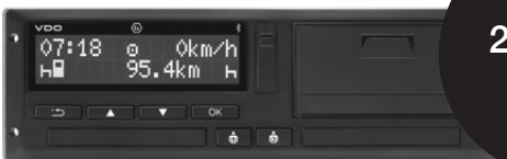
Tweede generatie slimme tachograaf EU Mobility Package-besluit: identificatie van laad- en losacties, detectie/registratie van landgrenspassages en authenticatie van GNSS-positie zijn vereist. Uitbreiding van het aantal controleberichten dat van afstand door controlerende instanties wordt gelezen. Deze tachograaf zal eerst als transitietachograaf worden uitgebracht, waarbij nog geen OSNMA positie-authenticatie plaatsvindt.
