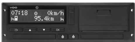
Annex 1C (1e versie slimme tachograaf) EU besluit: digitale tachografen op voertuigen > 3.5 ton dienen uitgerust te zijn met GNSS als onafhankelijk snelheidssignaal en voertuig-specifieke parameters moeten op afstand kunnen worden uitgelezen door controlerende instanties.
